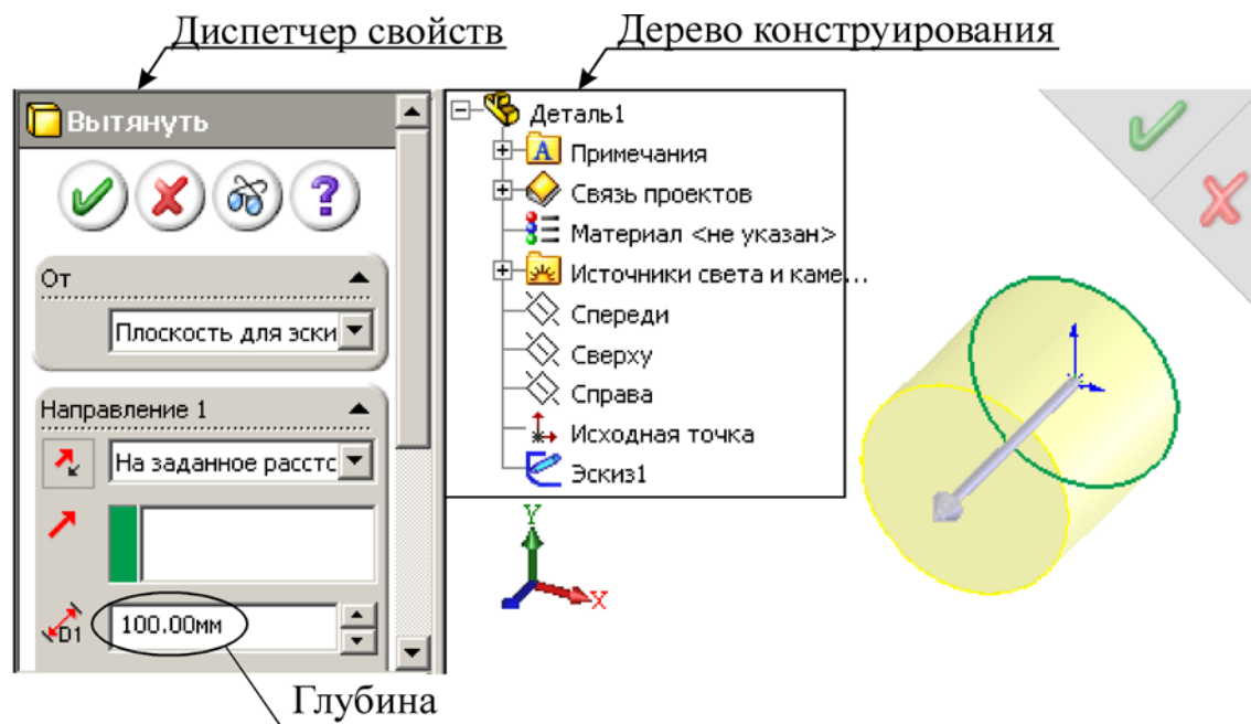
Рис. 1.2. Определение параметров элемента Вытянуть
