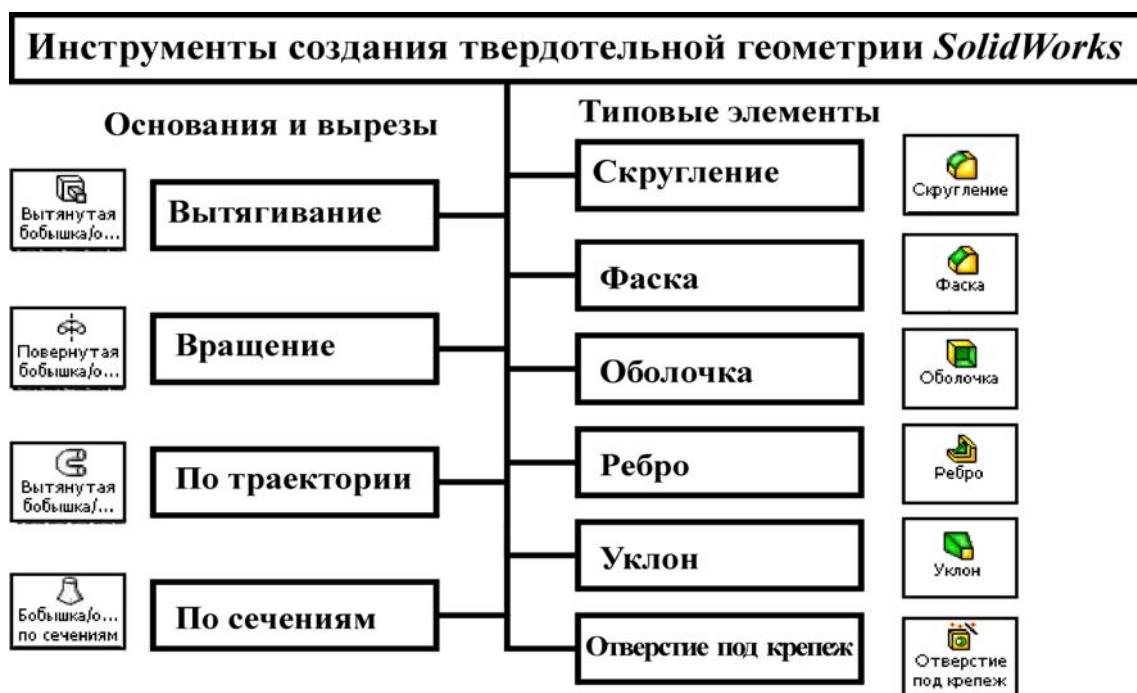
Рис. 3.1. Методы создания твердотельной модели в SolidWorks
